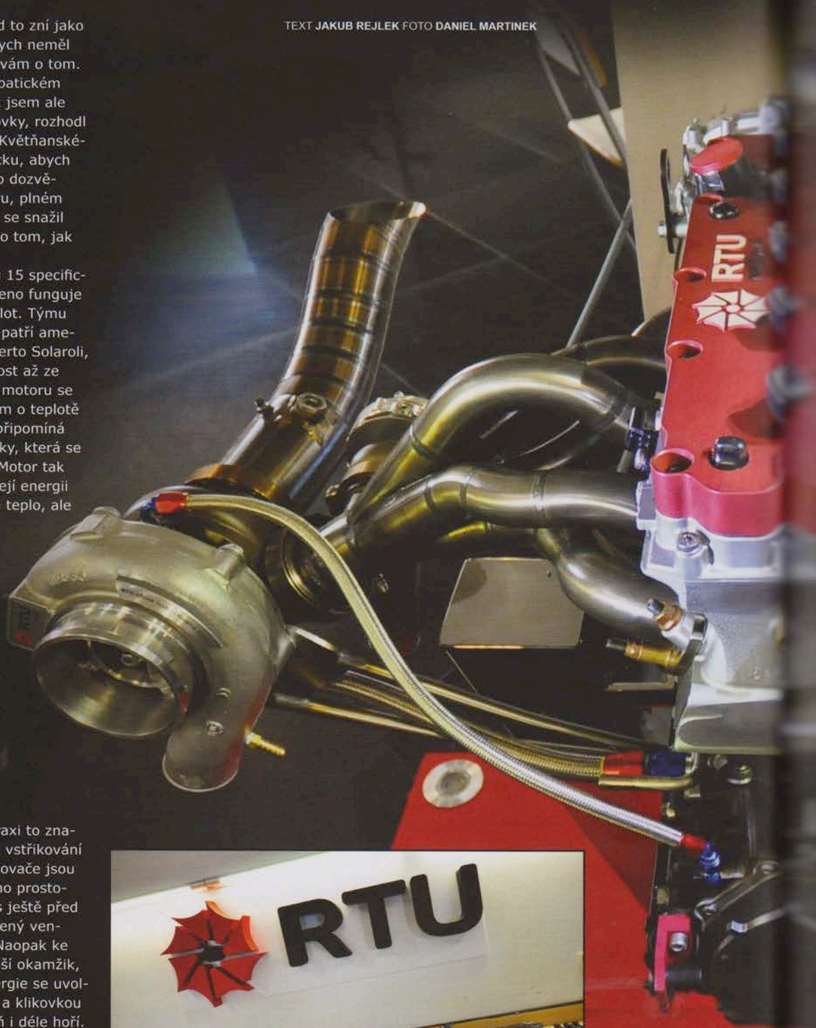
Společnost RTU připravuje také motor pro Pragu. To, co vidíte na stole, je přeplňovaný boxer.
